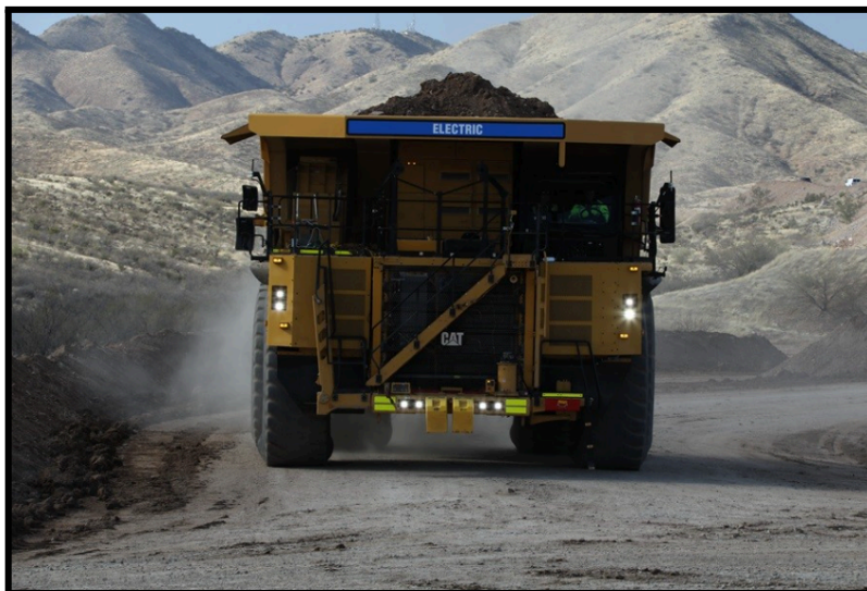
Figura 16: Caminhão fora de estrada movido a bateria elétrica.
