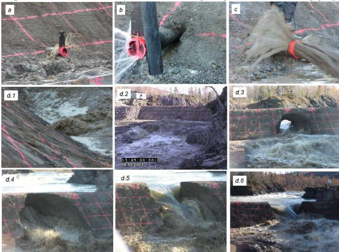
a) iniciação; b) continuação da erosão; c) progressão para formar tubo; d) formação da brecha
