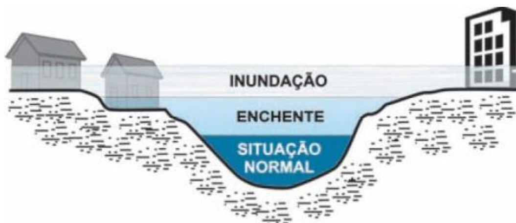
Figura 3-5 - Perfil esquemático do processo de enchente e inundação.
