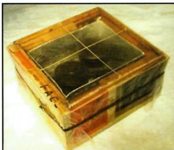
Figura 4. 5 Forno solar tipo caixa – Fonte: Página da Web:
