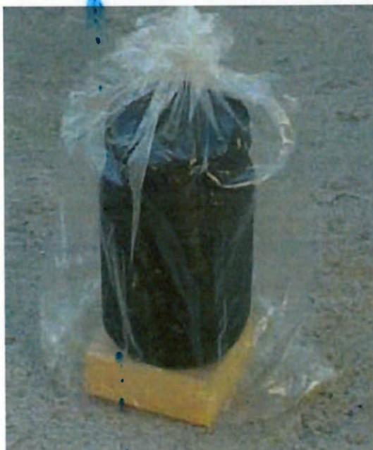
Figura 4.2 Forno solar tipo olla<solarcooking.org>
