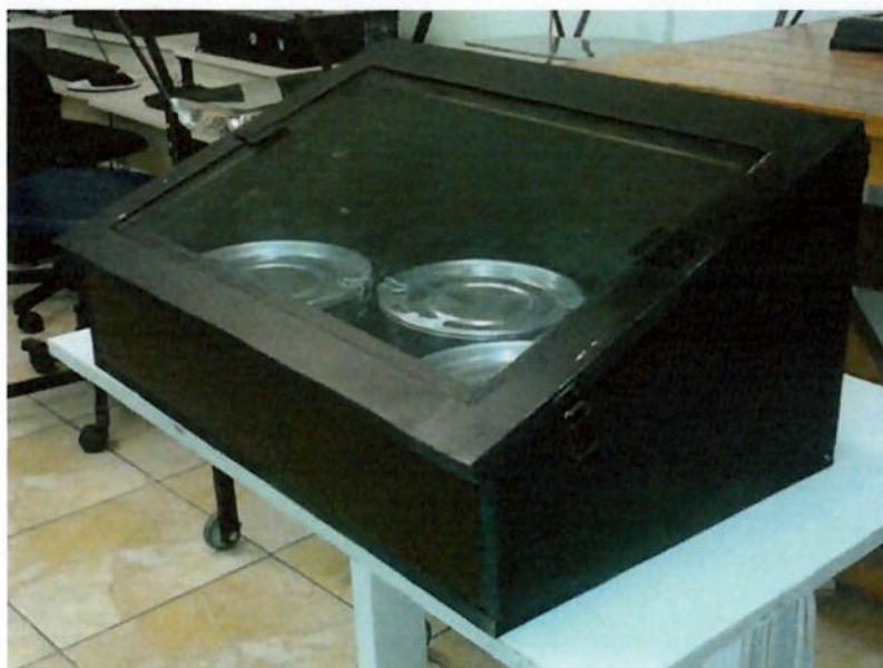
Figura 5. 6 Forno solar utilizado para o aquecimento de alimento.
