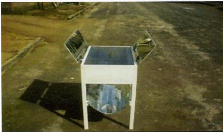
Figura 4.7 Forno solar tipo caixa confeccionado por Filho e Silva (2008).
