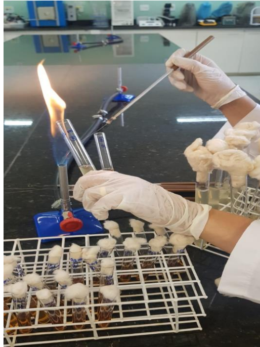
Figura 4.15 - Inoculação da porção da amostra positiva para o tubos contendo EC-MUG.
