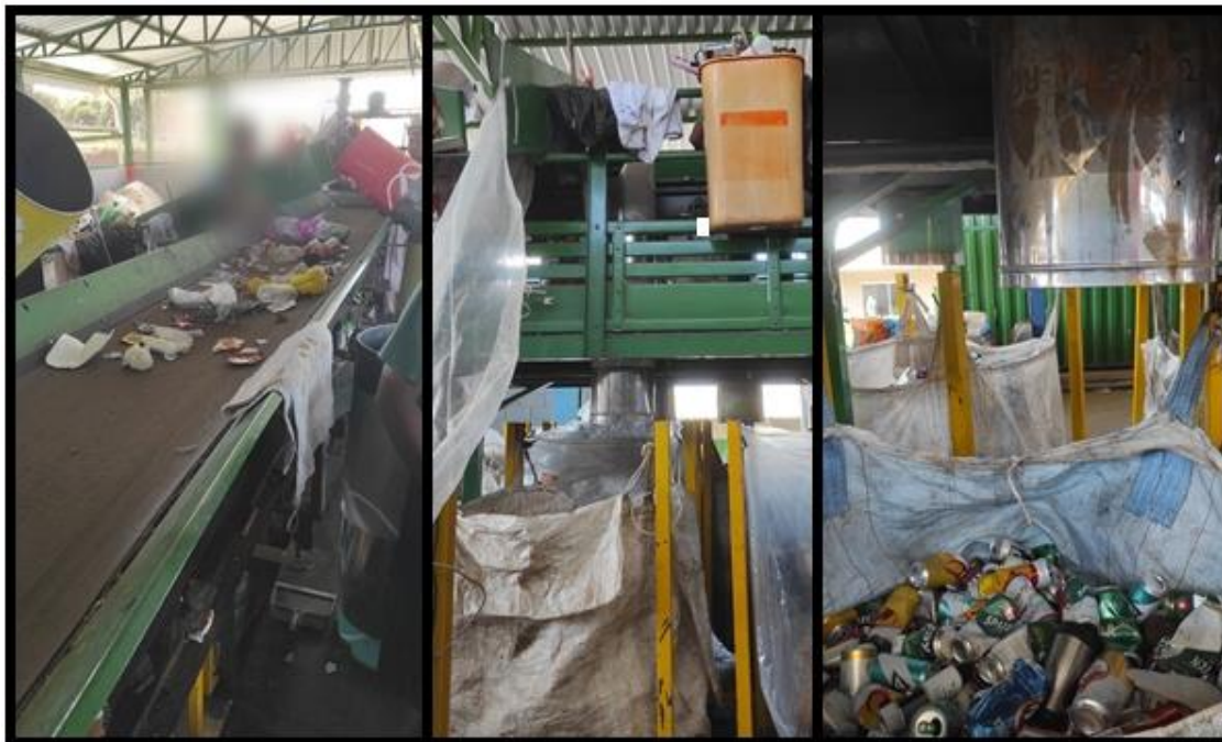
Figura 5.1 – Esteira de triagem e tubulações direcionadas às bags de material reciclável.
