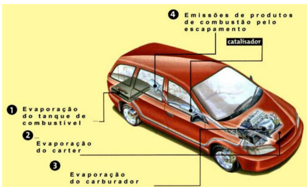
Figura 3.6 – Pontos de emissão de poluentes do ar em veículo automotor.
