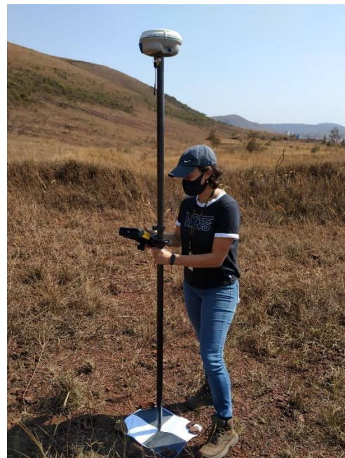
Figura 4.7 - Medição de alvo em campo com estação Rover.
