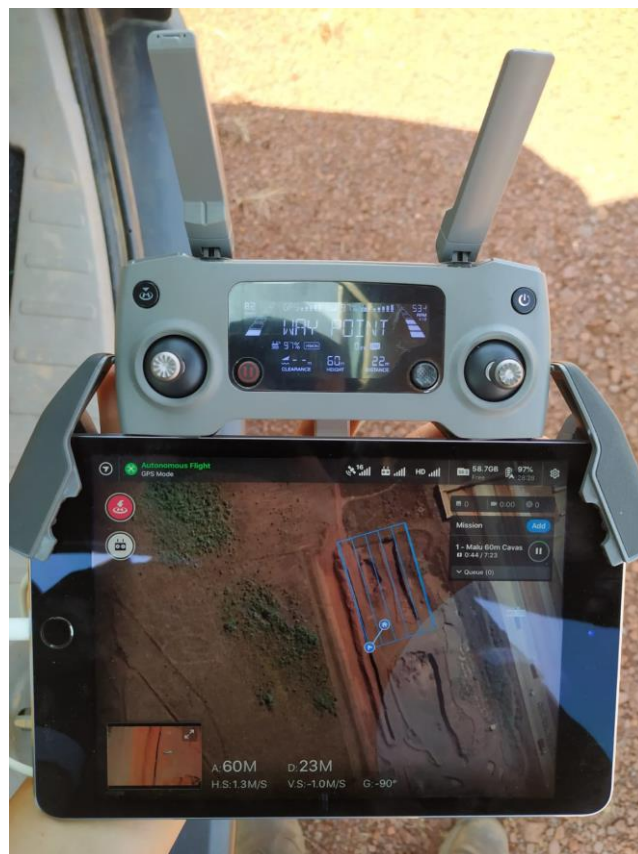
Figura 4.5 - Fotografia do controle do Mavic 2 Pro e tablet durante o sobrevoo sobre as CAVAS 2 e 3.
