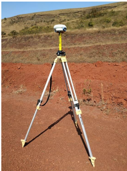
Figura 4.6 - Estação Base no local definido em campo.
