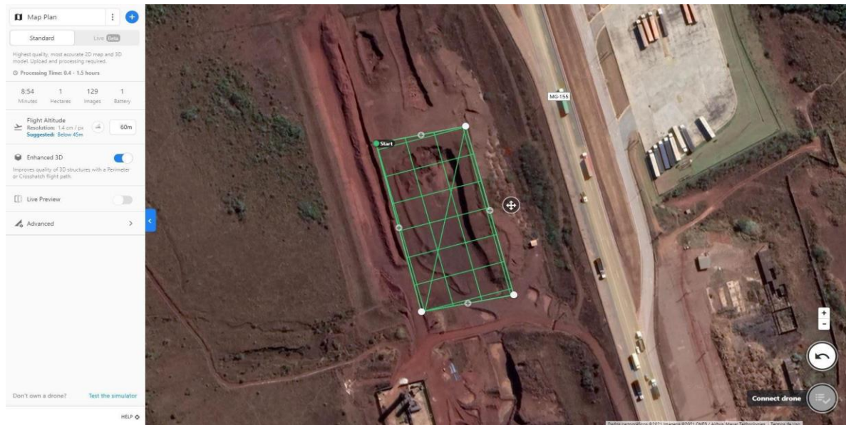
Figura 4.4 - Imagem de plano de voo realizado através do site Drone Deploy .
