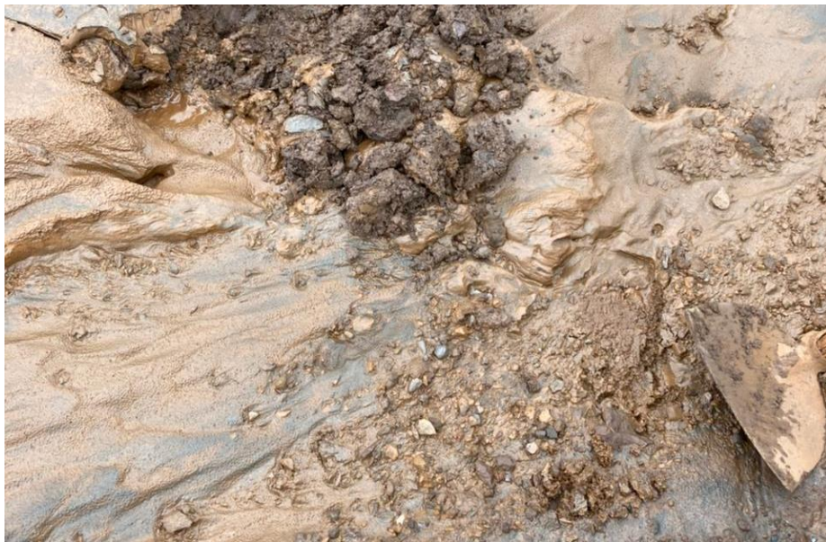
Figura 4.4 - Aspecto do Rejeito de Minério de Ferro na Sessão C da Barragem.
