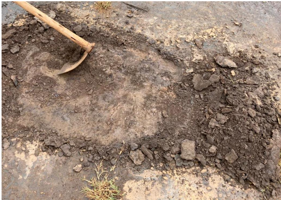
Figura 4.5 - Aspecto do Rejeito de Minério de Ferro na Sessão D da Barragem
