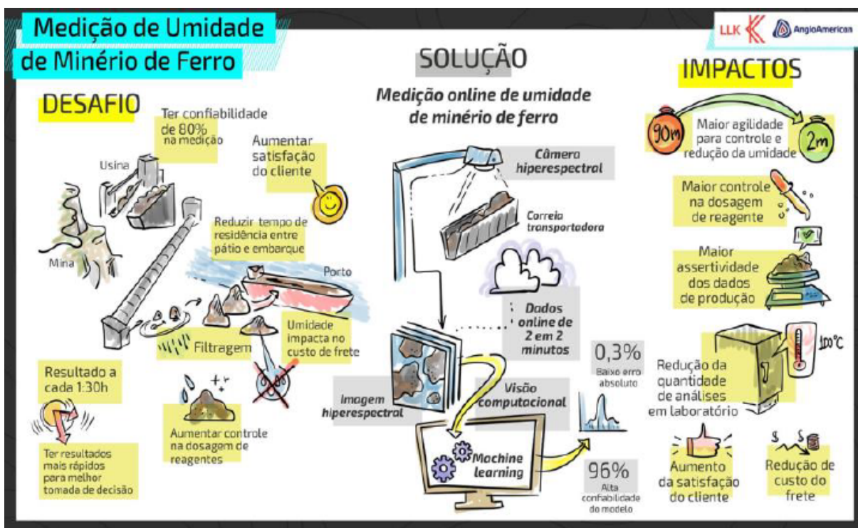
Figura 5.12 – Esquema ilustrativo do desenvolvimento da solução para medição da umidade do minério.
