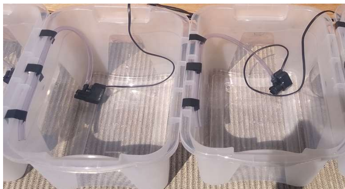
Figura 4: Bombas hidráulicas utilizadas para oxigenação
