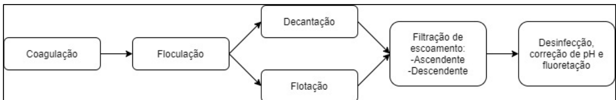
Figura 3.3 - Fluxograma típico da tecnologia de tratamento convencional.
