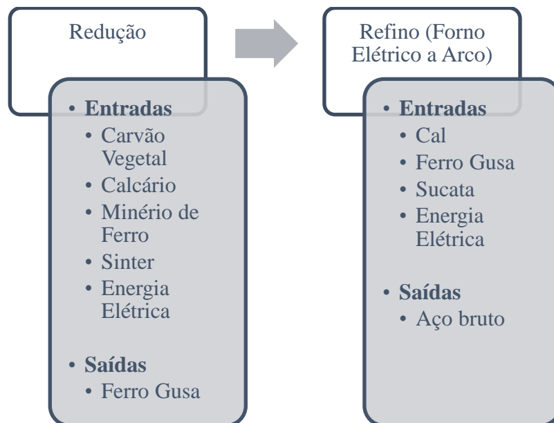
Figura 4.2 - Fluxograma dos processos da Usina B até a entrada da sucata.
